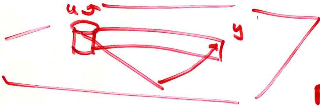
controllo di posizione del "tip" di un braccio flessibile
